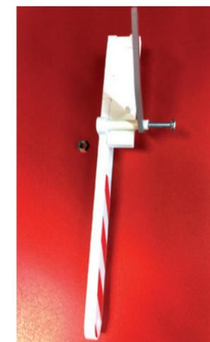
Monter l'ensemble sur le devant pilier (n° 54) à l'aide d'une entretoise (n° 45) dans l'axe préalablement fixé sur la bague d'arrêt. Faire passer l'axe par le petit trou de la pièce blanche.
