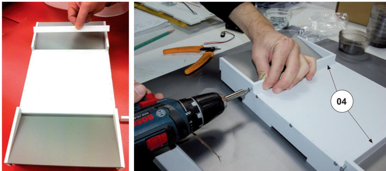
Bloquer la chaussée avec 4 vis Torx 3X13 (n°5).
