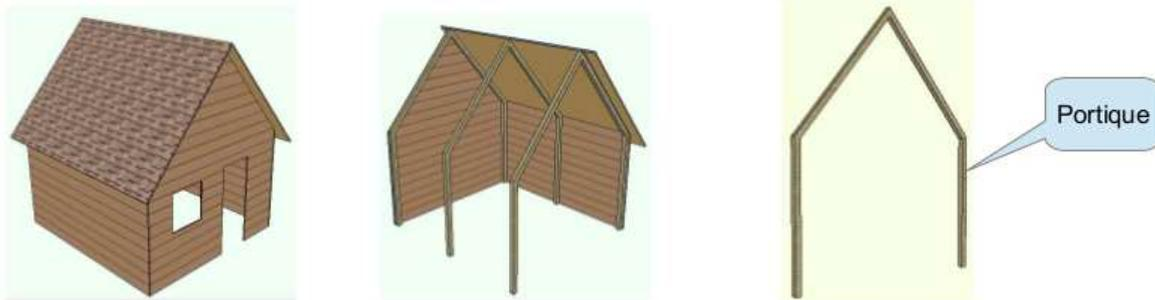
Pour étudier la stabilité du portique, nous allons utiliser un logiciel de **Résistance des Matériaux** qui permet entre autres de déterminer les déplacements des poutres sous une charge.
