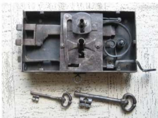
Une serrure à garnitures est constituée de composants métalliques. Le profil de la clé doit correspondre à la disposition des garnitures pour pouvoir tourner et déverrouiller le mécanisme. Ce système date de l'antiquité.
