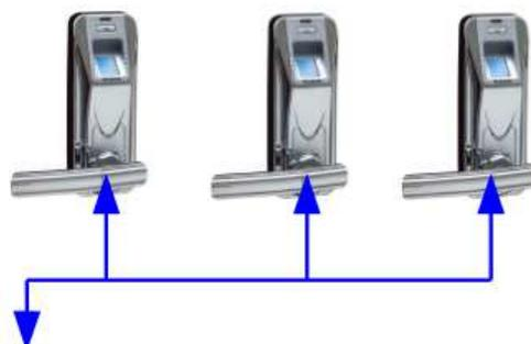
Une serrure biométrique est constituée d'un capteur d'empreinte ainsi que de composants mécaniques et électroniques. Elle est reliée à un ordinateur via un réseau. Si l'empreinte du doigt est reconnue par l'ordinateur, celui-ci déverrouille la porte.
