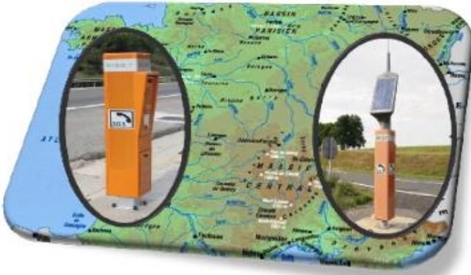
Le choix d'une solution technique peut dépendre du lieu géographique où l'objet est utilisé : le système de connexion au réseau téléphonique d'une borne d'appel située près d'une ville pourra utiliser une liaison filaire alors qu'une borne d'appel située en montagne utilisera une connexion par ondes radio).
